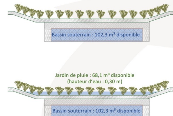
Jardin de pluie sur structure réservoir, Labourse, Picardie
